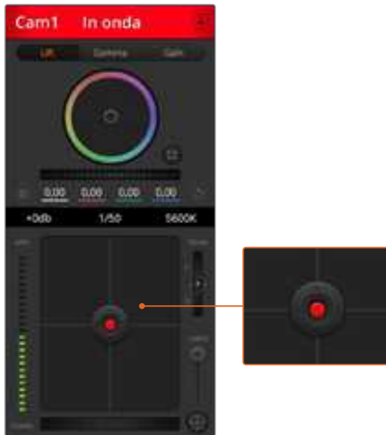
Il cursore circolare di controllo diaframma/livello del nero diventa rosso quando la camera è in onda
