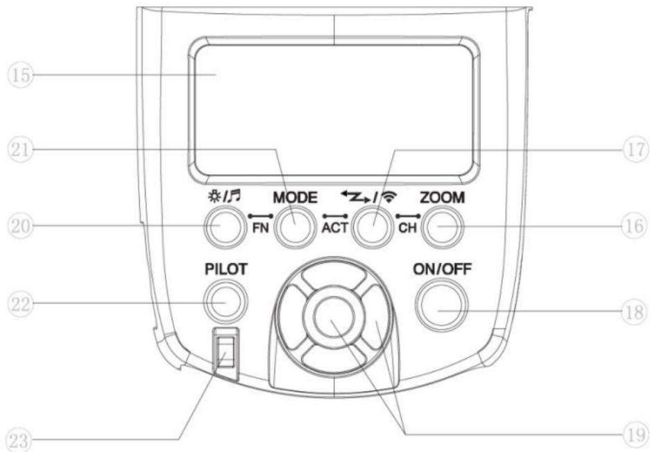
15. ЖК-панель, отображающая статус и установки.
