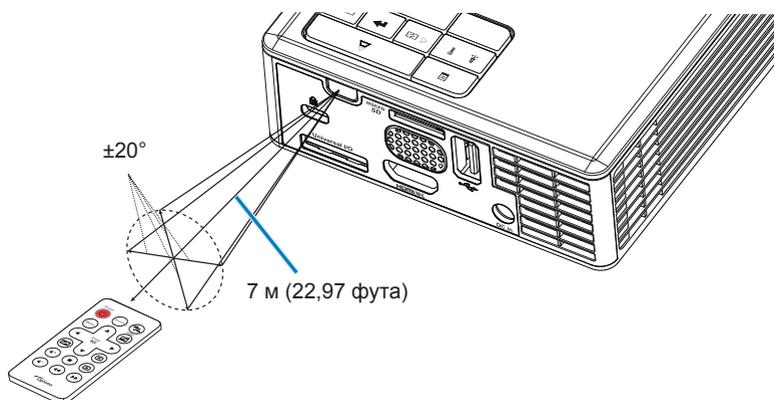
**ПРИМЕЧАНИЕ.** Фактический рабочий диапазон может немного отличаться от указанного на схеме. Кроме того, при разряженной батарейке зона действия пульта ДУ уменьшается или пульт ДУ перестает работать.
