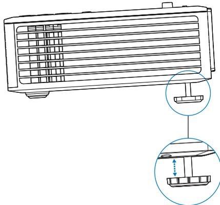
Переднее колесико регулировки наклона
