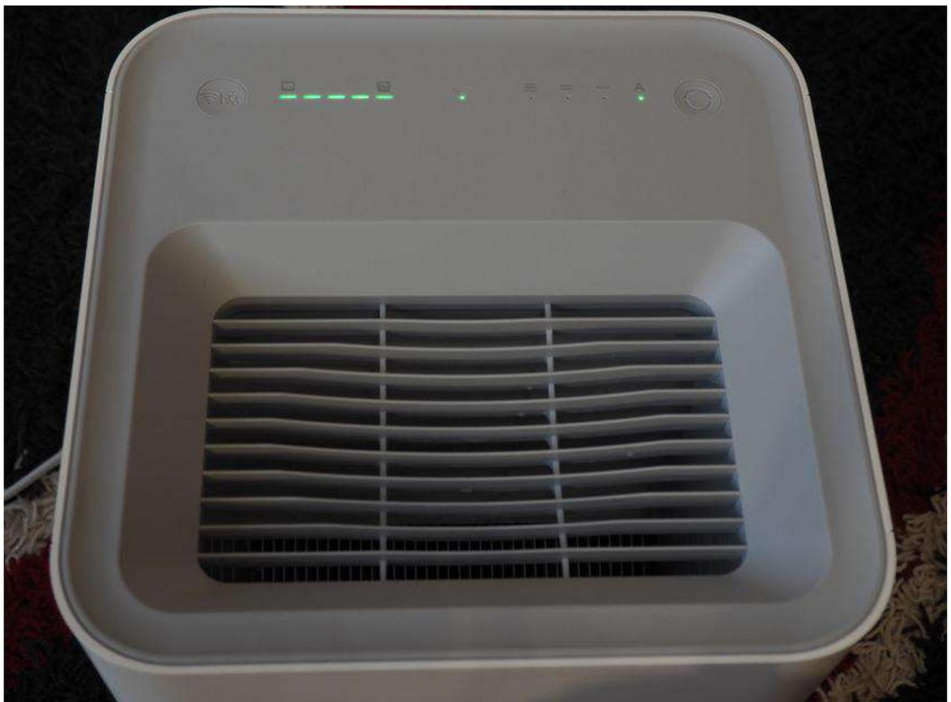
Левая кнопка позволяет управлять яркостью индикации в 3 доступных режимах: ярко, тускло и отключена. А правая кнопка включает увлажнитель и позволяет управлять скоростью вентилятора: 3 режима скорости и автоматический режим (режимы влияют только на скорость обдува вентилятором, скорость вращения барабана постоянная, 1 оборот за 23 секунды). Для отключения необходимо зажать кнопку на пару секунд.
