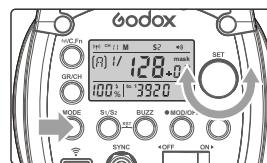
1 Нажмите кнопку режима высокоскоростной синхронизации. На дисплее появится значок ⚡.
